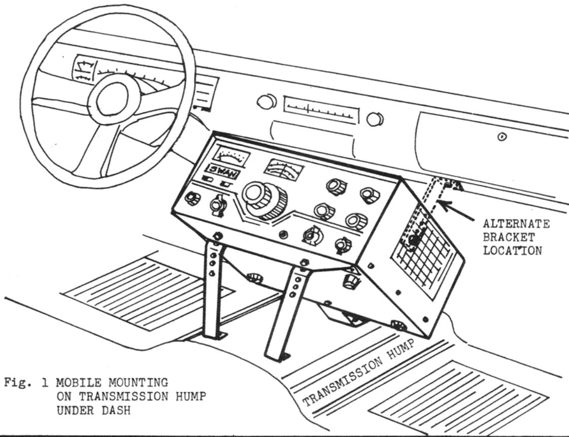
Fig. 1 MOBILE MOUNTING ON TRANSMISSION HUMP UNDER DASH
