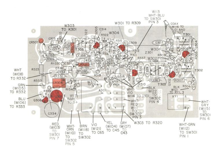
MONITOR RECEIVER PRINTED CIRCUIT BOARD COMPONENTS LAYOUT
